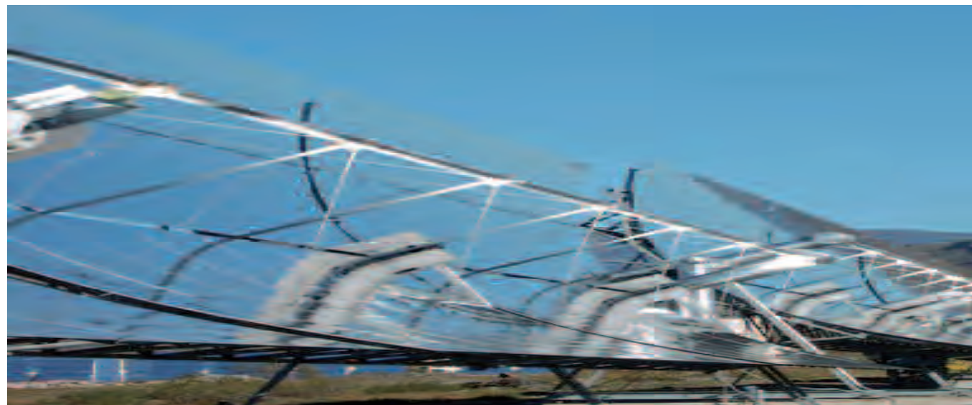
Colectores cilindro parabólicos.
